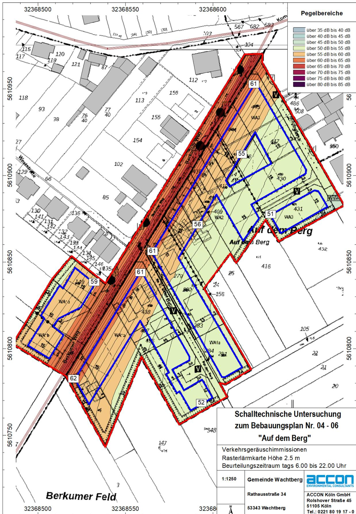
**Abb. 3.3.2** Verkehrsgeräuschsituation innerhalb des Plangebiets tags in Form einer Lärmkarte für eine freie Schallausbreitung in einer Höhe von 2,5 m (EG)
