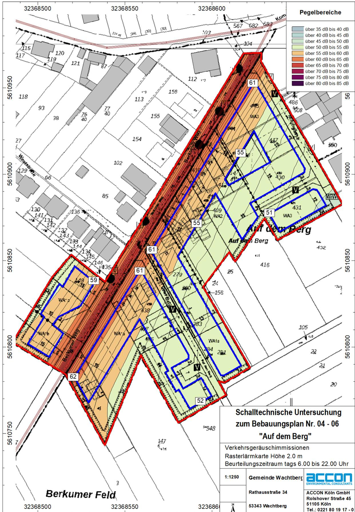
**Abb. 3.3.1** Verkehrsgeräuschsituation innerhalb des Plangebiets tags in Form einer Lärmkarte für eine freie Schallausbreitung in einer Höhe von 2,0 m (Außenwohnbereiche)
