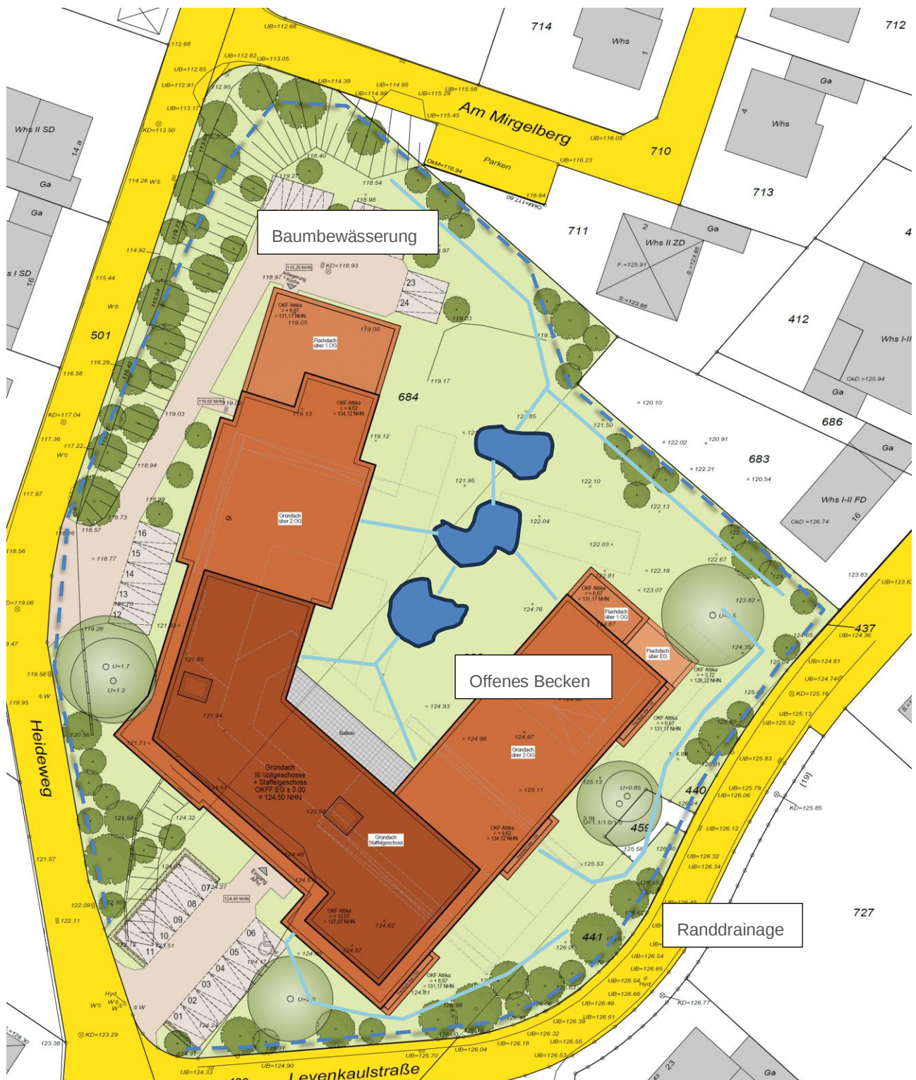
Abbildung 4: Grünflächenplan mit möglichen Retentionsräumen (skizziert) [Auszug aus Lageplan GRÜN-Entw 03 – Plan- & Bauwerk, Winsen / Aller GmbH 09.03.2023]
