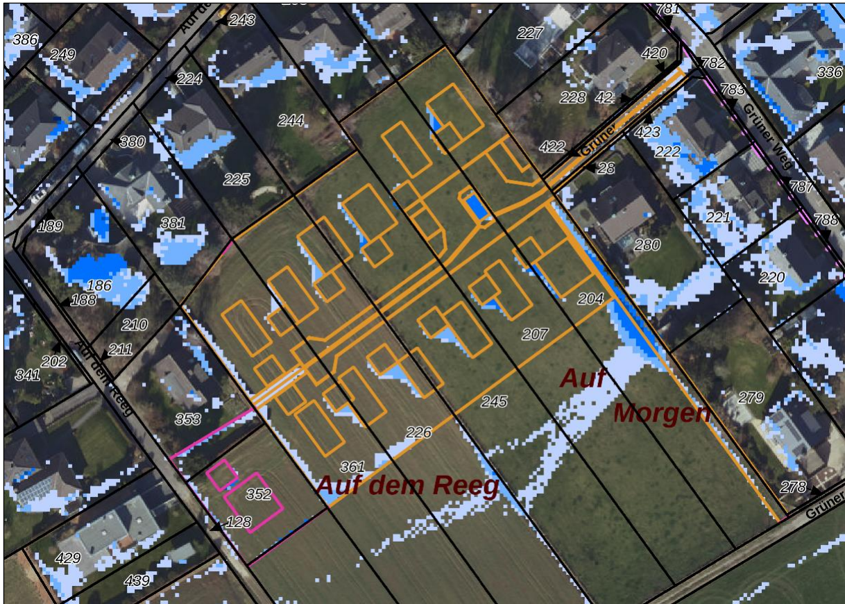
Abbildung 1-2: Ergebnisse Starkregenberechnung für das extreme Ereignis im Bereich des geplanten Bauvorhabens (gelbe Linie) sowie Flurstück 352 (pinke Linie) (Quelle: Hydrotec)
